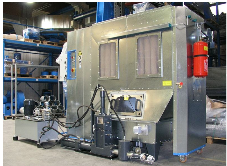
NE 300-as porszívó berendezés 3 forgácstárolóval A forgácstárolókban lévő műanyag zsákok egyszerűen, gyorsan cserélhetők.
